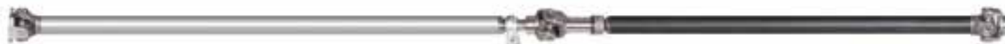
Barra de cardán tubular doble de 2" de diámetro para soplador, con extremos en brida serie 1310 y yugo de 1 1/4"
